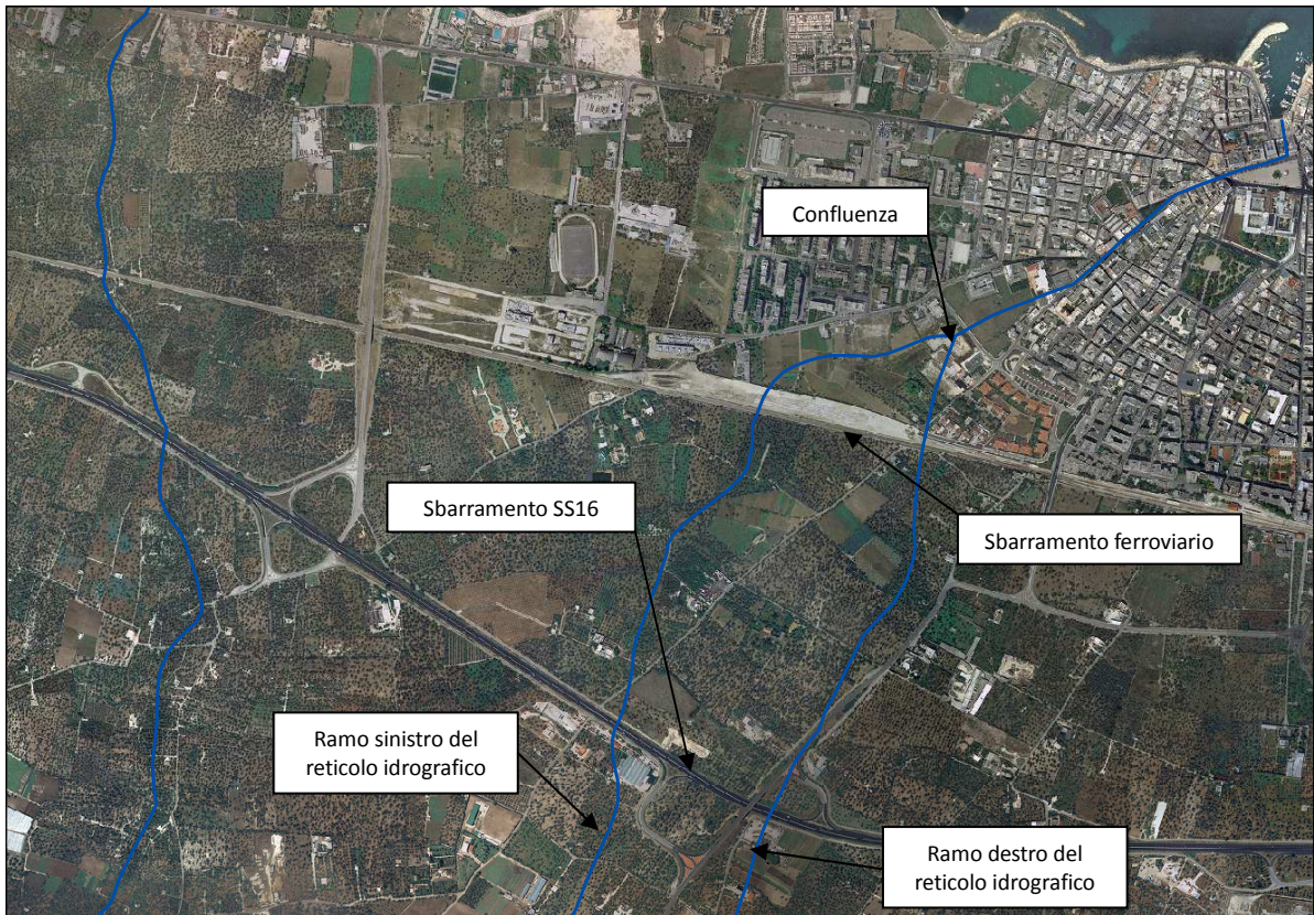
Inquadramento dell'area di intervento su ortofoto con indicazione del reticolo idrografico riportato sulla Carta Idrogeomorfologica della Regione Puglia.
