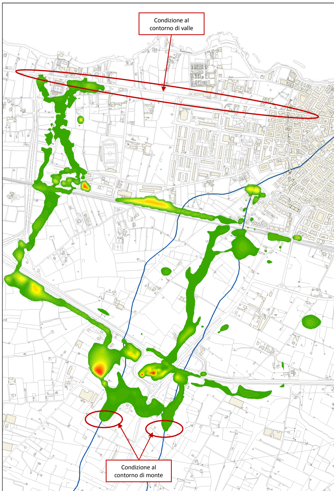
Output dei tiranti idraulici relativi alla simulazione con TR=200. I valori dei tiranti variano da 0,1 metri (verde) a 2,8 metri (rosso).
